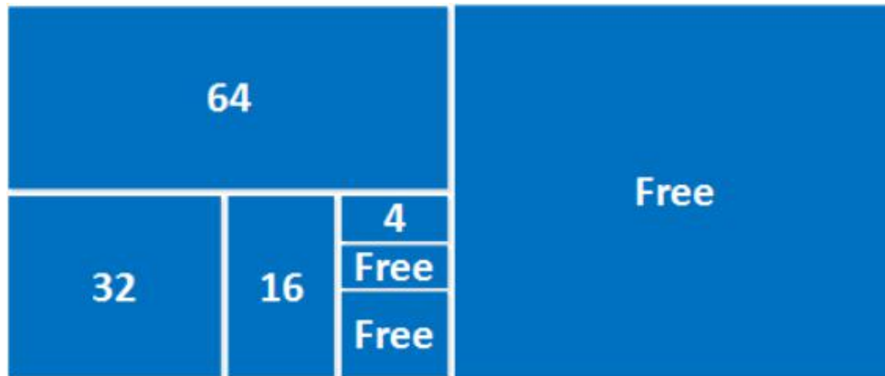
Gambar 4.3. Contoh pembagian IP menggunakan VLSM
